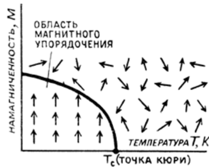
Рисунок 149 – Фазовый переход при температуре Кюри из ферромагнитного состояния в парамагнитное
