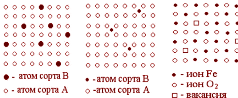
Рисунок 43 – Различные типы твердых растворов: a – твердый раствор замещения, b – твердый раствор внедрения, в – твердый раствор вычитания
