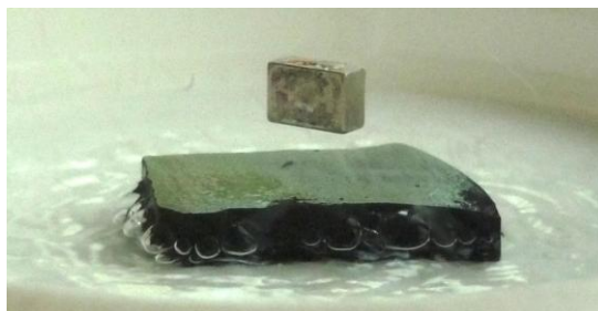
Рисунок 129 – Левитация магнита над ВТСП-керамикой
