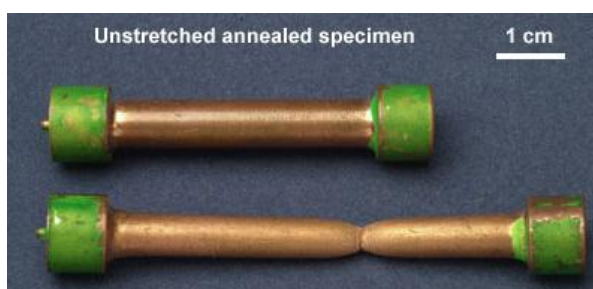
Рисунок 76 – Внешний вид образцов до растяжения (вверху) и после растяжения (внизу, видна шейка)
