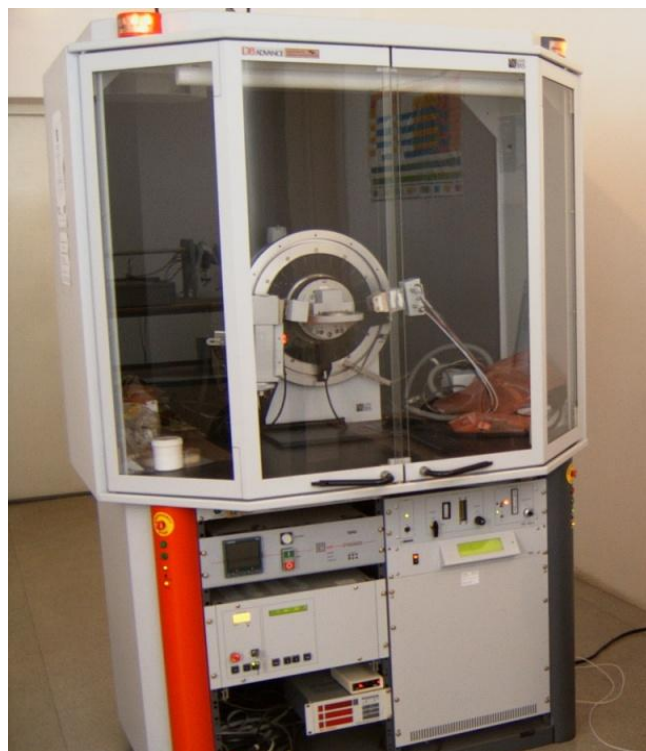
Рисунок 35 – Схема съемки рентгеновской дифрактограммы и вид дифрактометра D8 ADVANCE (Bruker AXS, Германия)
